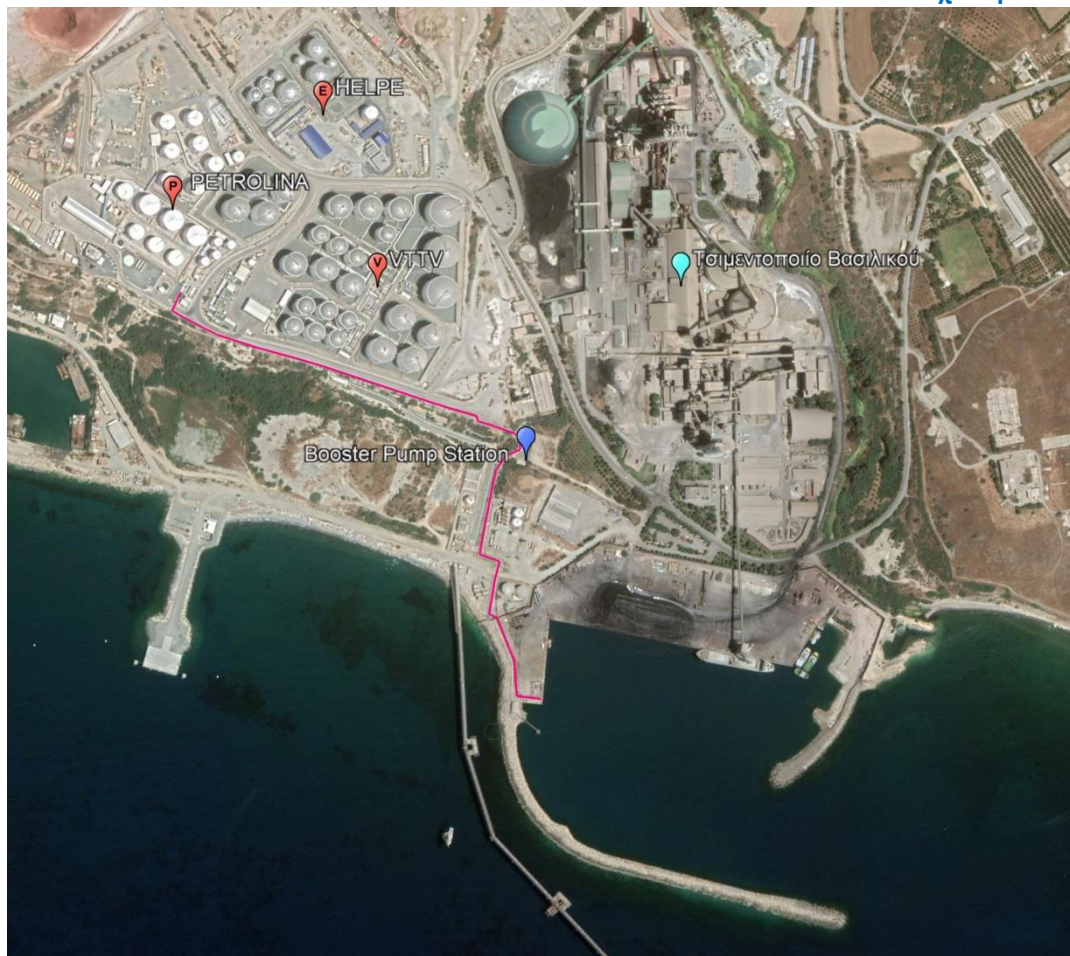
Εικόνα 4-8. Όδευση Αγωγών από λιμένα Βασιλικού μέχρι τερματικό Petrolina.
