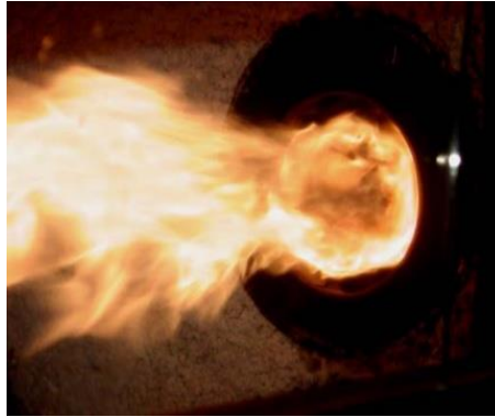
Σχήμα 1: Ορθώς ρυθμιζόμενη καύση
