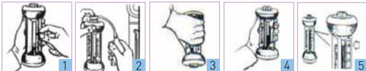
Σχήμα 5: Διαδικασία μέτρησης CO 2
