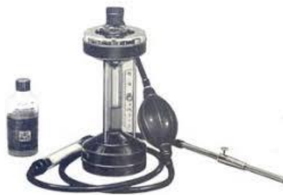
Σχήμα 4: Συσκευή μέτρησης της περιεκτικότητας καυσαερίων σε CO 2
