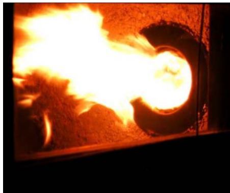
Σχήμα 2: Καύση με περίσσεια αέρα
