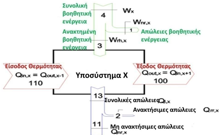
Σχήμα 13: Ενεργειακό ισοζύγιο υποσυστήματος
